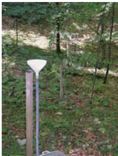
Fotografija 1. Prikupljanje padalina lijevcima na plohi u NP „Risnjak“ (Foto: B. Vrbeč) Photo 1 Collecting precipitation by funnels (bulks) on the plot in NP “Risnjak” (Photo: B. Vrbeč)
