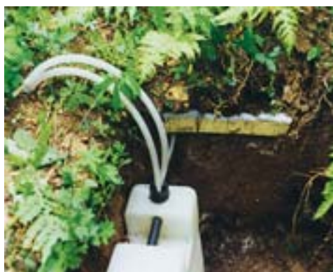
Fotografija 2. Lizimetar ispod humusnog horizonta (Foto: B. Vrbeč) Photo 2 Lysimeter beneath the hmus layer (Photo: B. Vrbeč)
