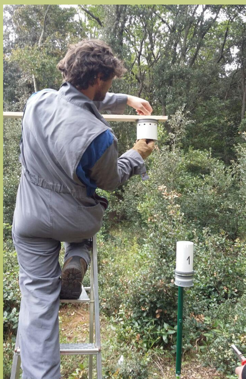
Postavljanje kišomjera i pasivnog mjerača ozona izvan šume
