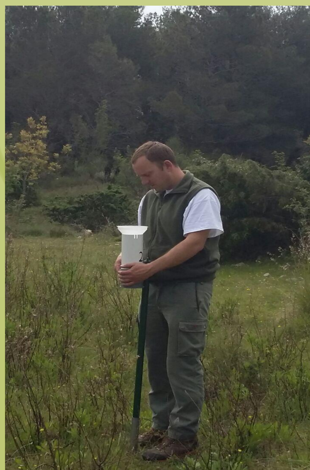
Postavljanje kišomjera i pasivnog mjerača ozona izvan šume
